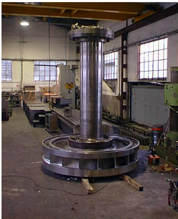
Монтаж вала и турбины Francis
