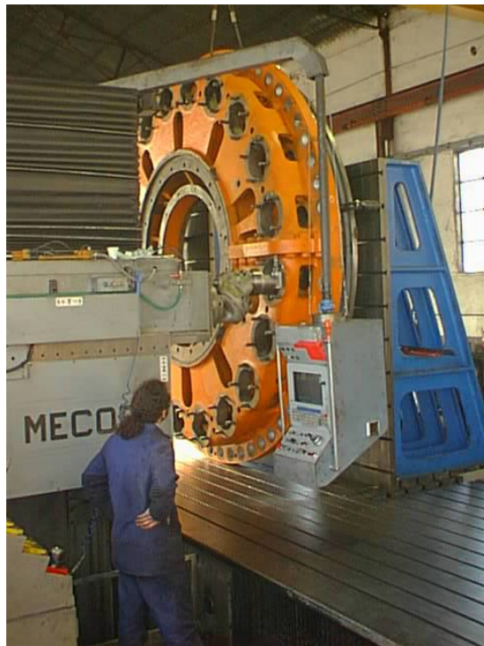
Крышка распределителя турбины Francis
